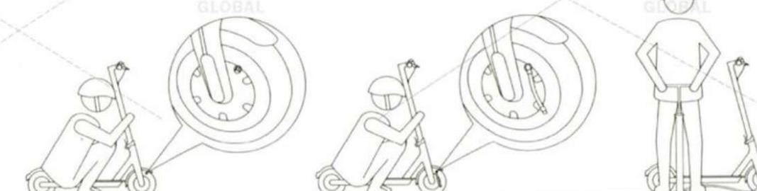
Если заднее колесо спущено, соедините трубку для накачки колес с ниппелем. Сначала снимите колпачок, затем затяните штуцер, после этого можно начинать накачивать колесо.
