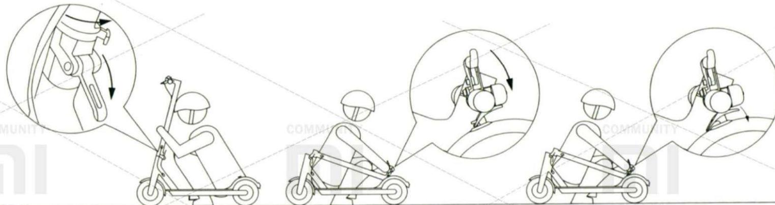
Убедитесь, что электросамокат выключен. Ослабьте фиксирующий рычаг и опустите рулевую стойку. Переведите рулевую стойку в горизонтальное положение и закрепите ее, вставив крючок в специальное кольцо, которое находится на заднем крыле. Чтобы собрать электросамокат, отсоедините рулевую стойку от крыла, переведите ее в вертикальное положение и зафиксируйте с помощью рычага.
